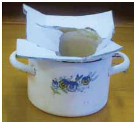
Рис. 5. После конденсации пара в кастрюле атмосферное давление сломало закрывающее её стекло
