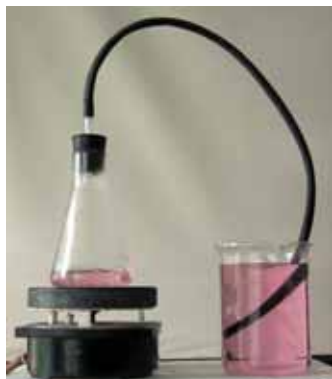
Рис. 1. Пар, образующийся при кипении воды, вытесняет из колбы воздух
