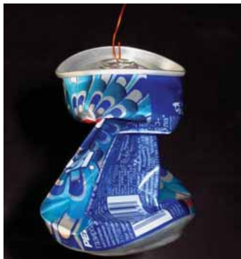
Рис. 3. Банка после конденсации в ней пара
