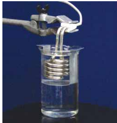
Рис. 1. Экспериментальная установка для наблюдения миража в стакане с водой
